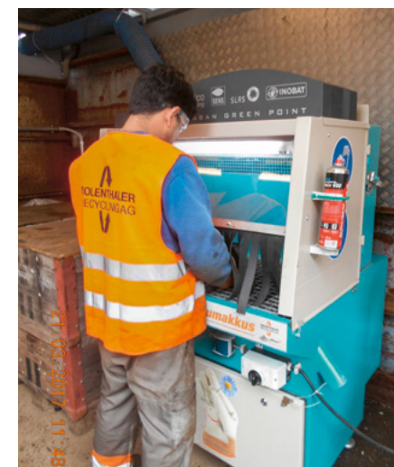
Potenziell gefährliche Geräte werden von speziell geschulten Mitarbeitenden an der Sicherheitswerkbank demontiert.
