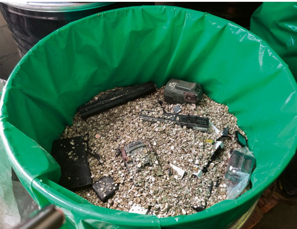
Das mineralische Vermiculit eignet sich ideal zur Aufbewahrung von Gefahrgütern: Es hat einen hohen Schmelzpunkt, ist nicht brennbar, leitet Wärme und Elektrizität schlecht und speichert Feuchtigkeit.
